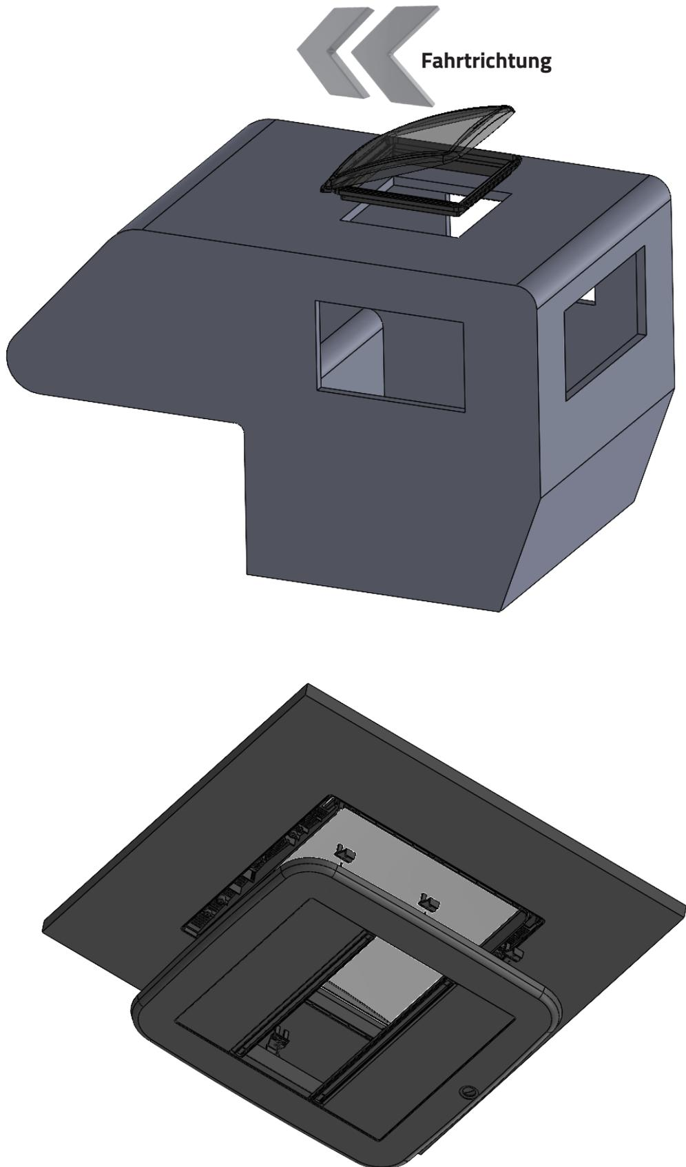
Innenrahmen auf Befestigungsböcke aufklipsen. Die Federklammern sind bereits werksseitig in dem Innenrahmen montiert.
